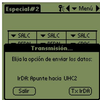
Figura 2: Para descargar una configuración de gabinete, sostenga la unidad Palm paralela al piso y a un pie [30 cm] del lente del gabinete en la esquina superior derecha. Pulse el botón RX Mnems. Para descargar un registro de la actividad diaria, pulse el botón Rx logs [Recibir registros]. Aparecerá un cuadro de diálogo después de terminarse la transferencia.
